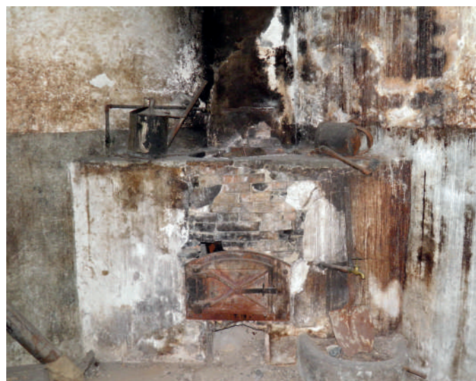
Fogón con regaderas metálicas que debían servir para escaldar la pasta en la prensa.
