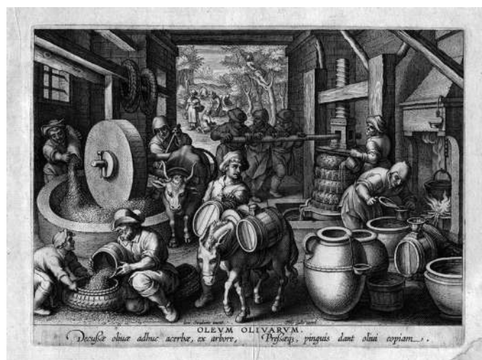
El proceso de producción del aceite recurriendo a una prensa de husillo (Grabado de Iohan Stradamus, hacia 1591).
