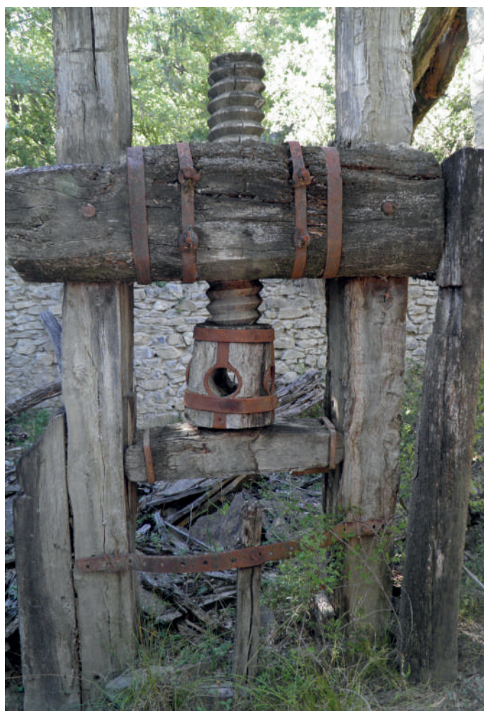
Prensa de husillo de madera. La pieza de la izquierda presenta una moldura que nos hace pensar si no pudo formar parte antes de una prensa de viga.
