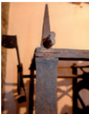
Marcas de ensamblaje del reloj de San Chuan. Pilares del 1 al 3. Fijación con cuñas de hierro
