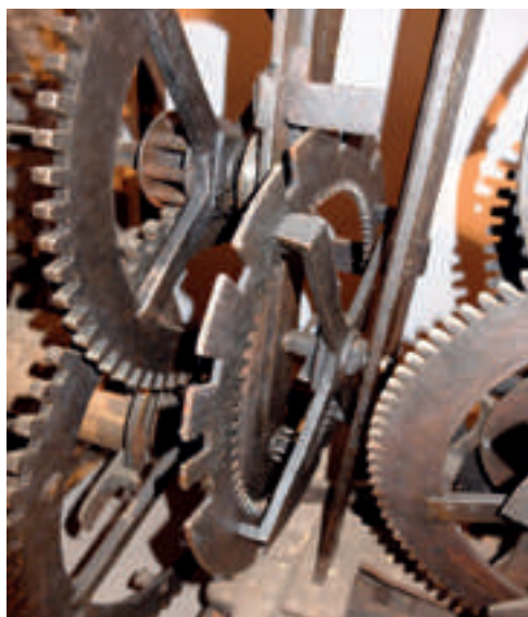
Rueda contadora del tren de horas del reloj de San Chuan de Plan, en el centro. En este caso el retén se encuentra sobre el saliente que hace sonar las seis (la primera hora carece de saliente por su brevísimo recorrido por lo que actúa dentro de la primera muesca). Se observa cómo los salientes van haciéndose más anchos, determinando un mayor número de campanadas
