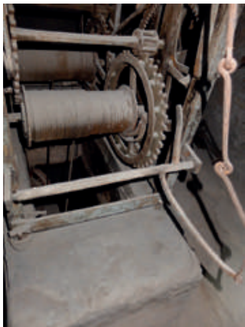
Palanca separada de las clavijas que impulsan la misma para dar las campanadas en el reloj de Gistaín
