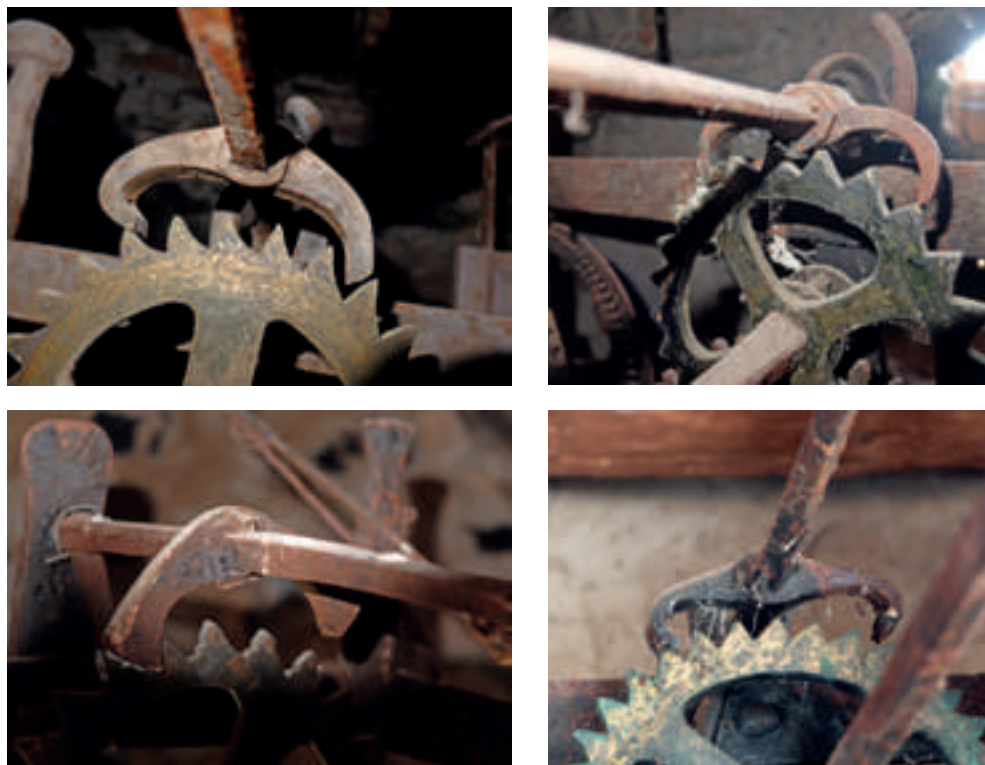
Escapes de áncora de tipo y acabado diverso de Chistén –arriba a la izquierda– y en el sentido de las agujas del reloj, los de Javierre, Buerba y San Felices
