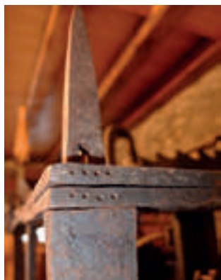
Marcas de ensamblaje y posición del reloj de San Chuan. Pilar 4, soporte del eje del escape y pletina
