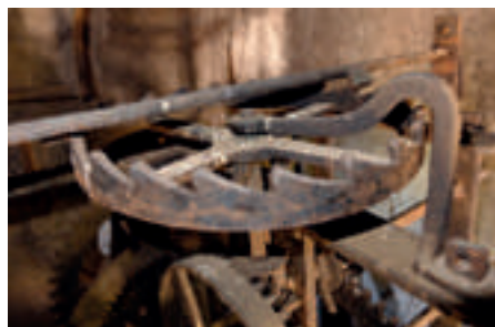
Escapes de paletas de San Chuan de Plan y Serbeto. Se aprecia la gran similitud entre ellos
