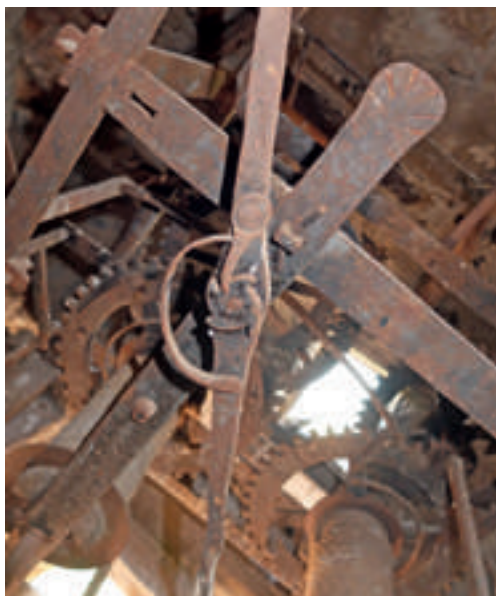
Trinquete y rochete del venterol del reloj de Buerba
