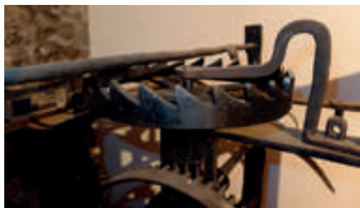
Escapes de paletas de San Chuan de Plan y Serbeto. Se aprecia la gran similitud entre ellos
