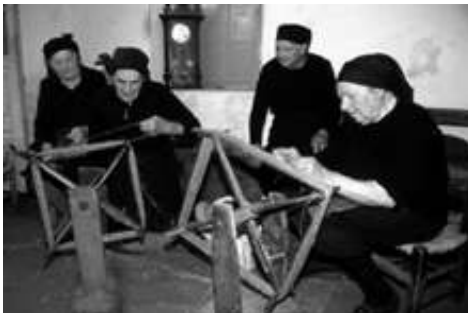
Con el dimuré las “fusadas” se convierten en madejas
